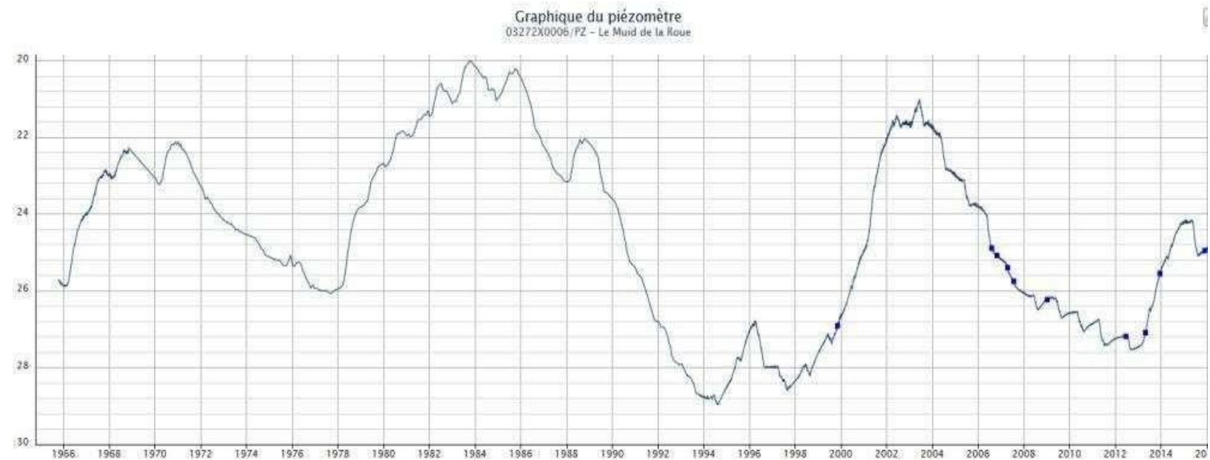
Courbe piézométrique 1978-2015 au piézomètre de Trancrainville situé en Beauce centrale (capte les calcaires de Pithiviers et les calcaires d'Etampes) - prof. en m/repère de mesure
